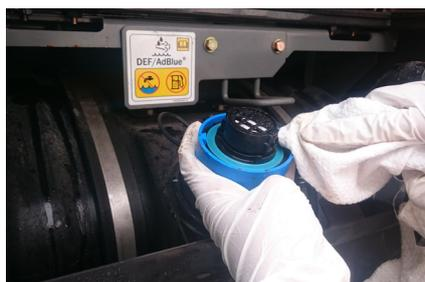
Entfernen Sie regelmäßig Ablagerungen auf Deckel und Dichtring. Beim Verschließen des Tankdeckels immer auf korrekten Sitz des Deckels achten.
