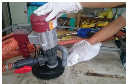
Reinigen Sie den Bereich um den Pumpenauslass und achten Sie darauf, dass keine Fremdkörper in den Tank gelangen.
