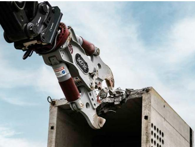
DCC Abbruchscheren mit zwei Zylindern sind speziell für den Rückbau von Objekten mit großen Wandstärken und Armierungen entwickelt: z.B. Brückenpfeiler, schwere Fundamente, Viadukte. Das 2-Zylinder-Konzept erlaubt eine symmetrische Bauform, damit sind die Scheren besonders gut für Longfront-Einsätze geeignet.
