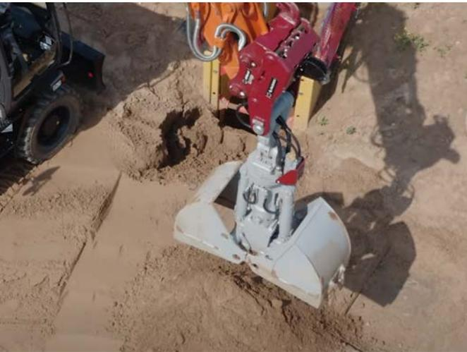
Ob im Verbau, auf der Kanalbaustelle, in der Rückverladung oder bei universellen Einsätzen bieten die Zweischaalen-Tiefbaugreifer über das natürliche Einsatzspektrum eines Tief- oder Grabenlöffels hinaus weitreichende Vorteile. Gezieltes Greifen, kraftvolles Graben oder die Bewältigung schier endloser Verladearbeiten sind mit einem Zweischaalengreifer kein Problem!
