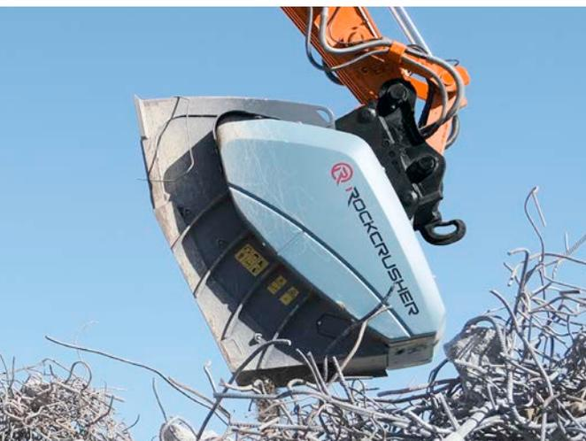
Die einzigartige Brechbewegung (Quatro-Bewegung) garantiert höhere Durchsatzleistung und einen größeren Anteil am kubischen Endprodukt. Blockierungen während des Brechens werden durch die Rückwärtsfunktion einfach und schnell gelöst.
