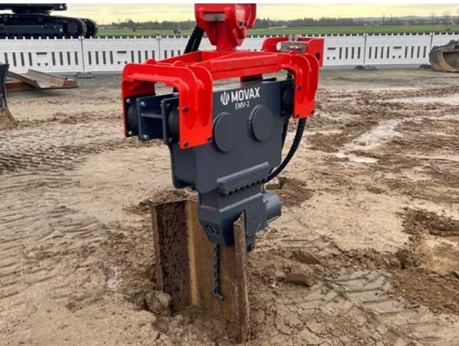
Für kleinere, einfachere Bauvorhaben sind die MOVAX EMV Rammgeräte besonders geeignet: die konventionelle Hydraulikversorgung des Baggers ist ausreichend, es wird keine zusätzliche Steuerung benötigt. EMV Rammen arbeiten im Hochfrequenzbereich und sind damit perfekt für Rammanwendungen selbst bei schwierigen Bodenverhältnissen geeignet.
