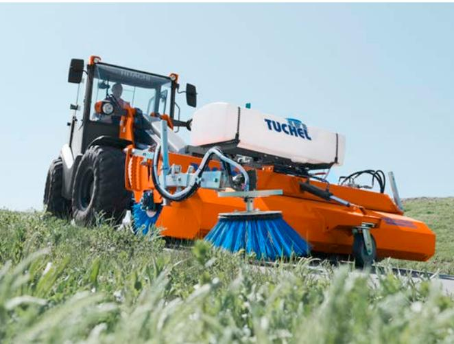
Hydraulisch angetrieben für Radladeranbau, Kommunalfahrzeuge oder Traktoren. Robuste Besen, leistungsstarke Antriebsmotoren und mit zahlreichen Ausstattungsmöglichkeiten:
