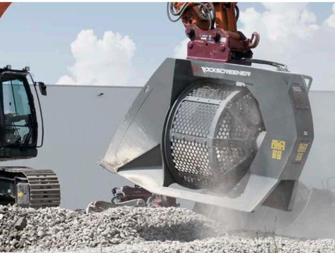
Die Rockscreeener sind unverzichtbare Werkzeuge für das Absieben von Feinanteilen aus Materialien für unterschiedliche Verwendungen. Durch das große Ladevolumen können große Mengen schnell und mit geringem Aufwand getrennt und weiterverarbeitet werden.
