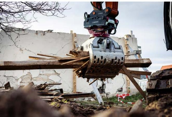
Unsere Abbruch- und Sortiergreifer von DEMAREC sind ideal für Arbeiten im Abbruch, Recycling und GaLaBau ausgelegt. Die robuste Konstruktion des Demabox Schalenträgers und großzügig dimensionierte Lagerungen halten größten Belastungen stand.
