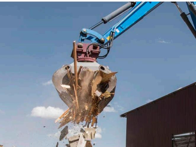
Unsere Abbruch- und Sortiergreifer von DEMAREC sind ideal für Arbeiten im Abbruch, Recycling und GaLaBau ausgelegt. Das vollständig geschlossene Greifergehäuse arbeitet wartungsfrei und ist wasser- und staubdicht. Bei permanent konstanter Schließkraft und -geschwindigkeit behalten Sie stets die Kontrolle.
