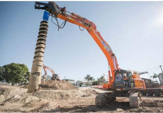
Die robusten Erdbohrer sind eine wirtschaftliche und maßgeschneiderte Lösung zum Bohren von Löchern. Ihr modularer Aufbau erlaubt die Kombination von starker Antriebseinheit, individuellem Schnecken-durchmesser und einfach austauschbaren Verschleißteilen. Mit wenigen Handgriffen kann bei Bedarf am Einsatzort eine Verlängerung eingefügt werden, für noch mehr Effizienz beim Tieflochbohren.
