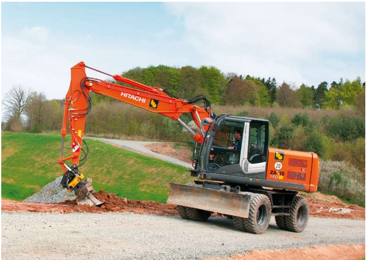
Hitachi Mobilbagger ZX140W-3 mit Tilt-Rotator
