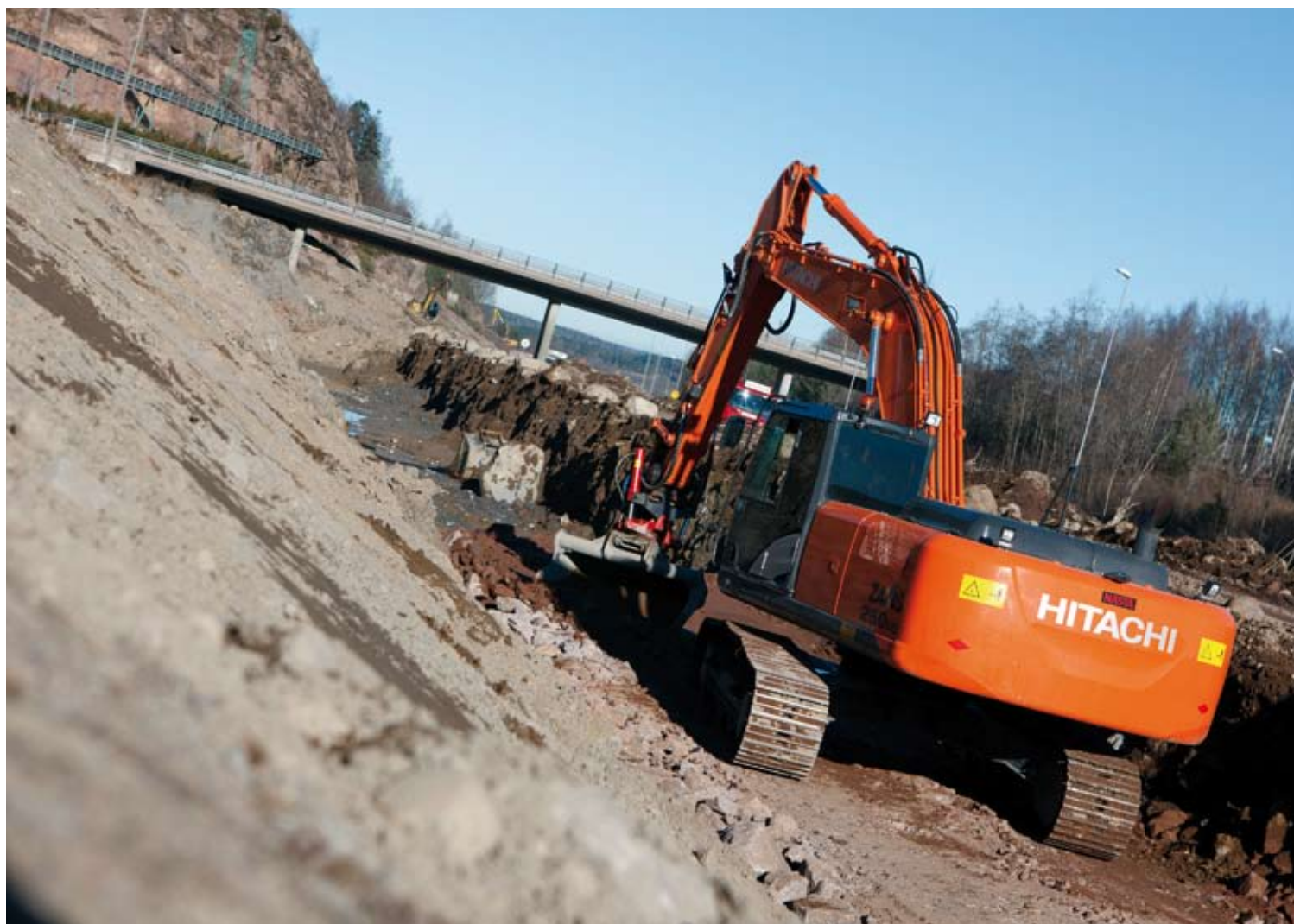
Hitachi Kettenbagger ZX250LC-5 mit Tilt-Rotator
