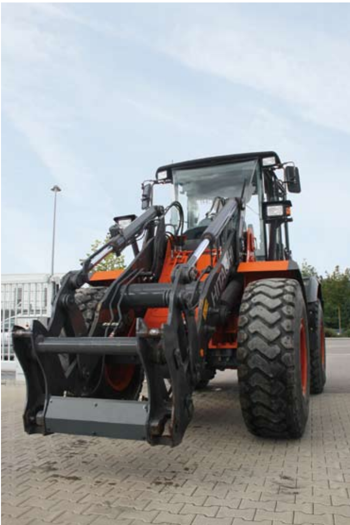
Hitachi ZW140PL mit markenkompatiblen Schnellwechsler
