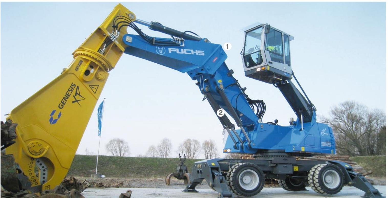
KMC355 BT mit Kiesel Boom Quick Connect (1) und Kiesel Tritec (2)
