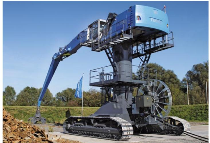
Terex Fuchs RHL880D XL-trac mit Pylon und Kabeltrommel
