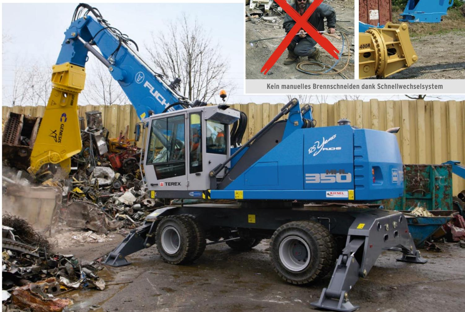
Kein manuelles Brennschneiden dank Schnellwechselsystem
