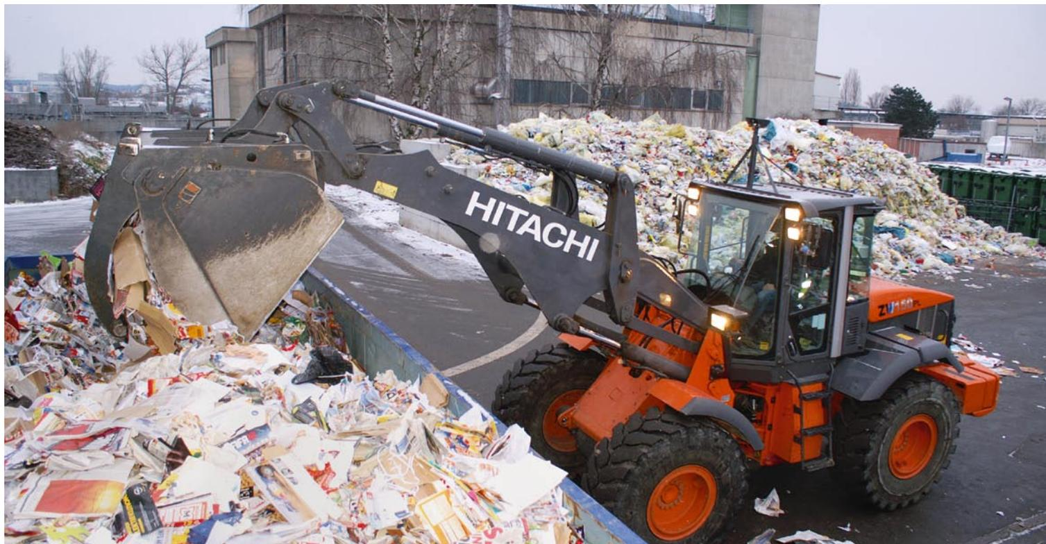
Hitachi Radlader ZW150PL Super-High-Lift mit Niederhalterschaukel
