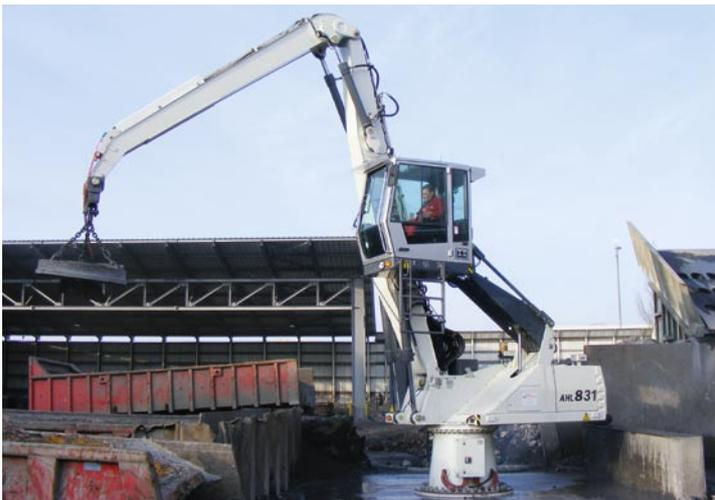
Terex Fuchs AHL831D mit Stahlpylon-Aufbau
