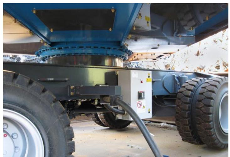
Sicherungskasten mit Schleppkabel am Unterwagen
