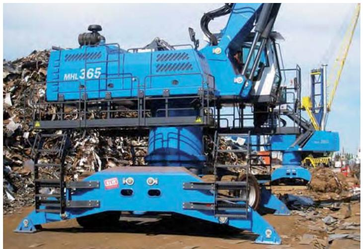
Terex Fuchs 1,4 m Pylon und Wartungsrundläufen
