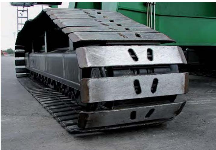
Flachbodenplatten aus Gussstahl
