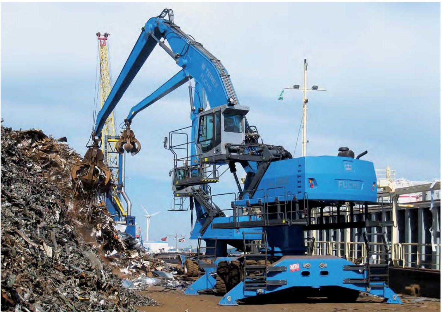
MHL360D Pylon und MHL365D Pylon bei der Schiffsverladung
