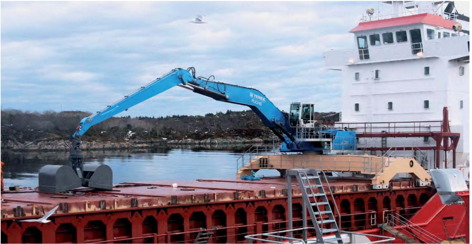
Terex Fuchs AHL380D mit Schienentraverse
