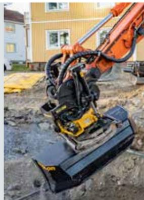
RotoTop dreht Anbaugeräte in jede Richtung: auch außerhalb der konventionellen Arbeitsrichtung des Trägergeräts.
