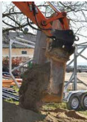
Werkzeugwechsel in Sekunden: der Maschinenführer muss die Kabine nicht verlassen.
