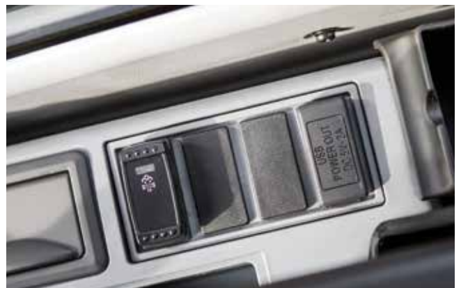
Gniazdo zasilania USB umożliwia ładowanie urządzeń przenośnych, takich jak telefony komórkowe.
