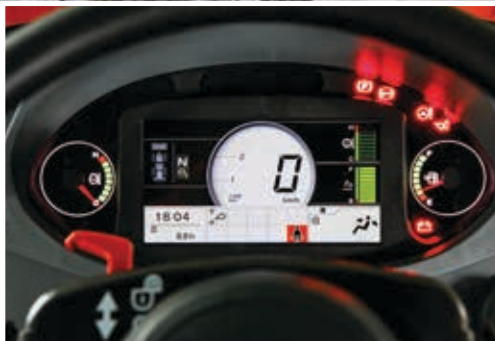
Monitor LCD przedstawia stan i ustawienia maszyny.
