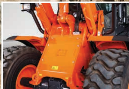
Rama przednia ładowarki ZW150-6 została wzmocniona.
