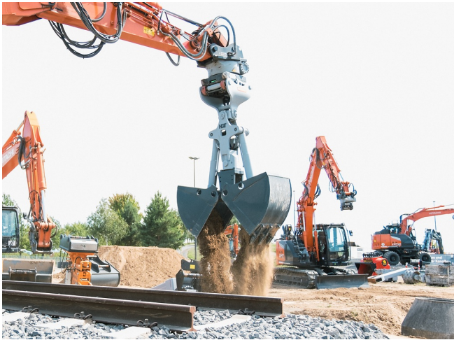
Maximale Reichweite und Flexibilität: Graben über Hindernisse hinweg
