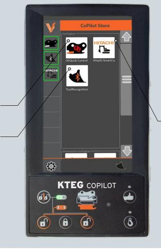
Automatische Einstellung der korrekten Anbaugeräteparameter wie Öldruck, Litermenge und Arbeitsmodus des angekuppelten Anbaugeräts
