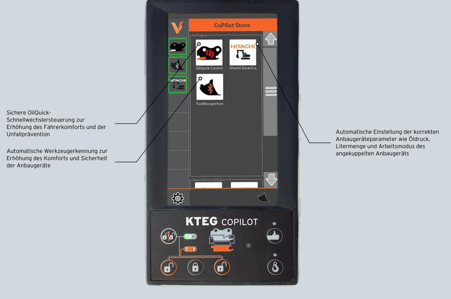
Sichere OilQuick-Schnellwechslersteuerung zur Erhöhung des Fahrerkomforts und der Unfallprävention
