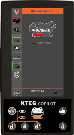
Doppelt abgesicherte Verriegelungskontrolle
