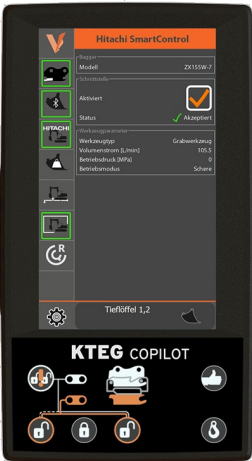
Automatische Werkzeugerkennung und -einstellung
