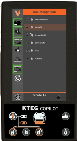
Automatische Werkzeugerkennung und -einstellung
