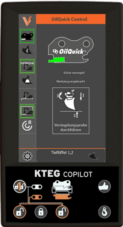
Doppelt abgesicherte Verriegelungskontrolle
