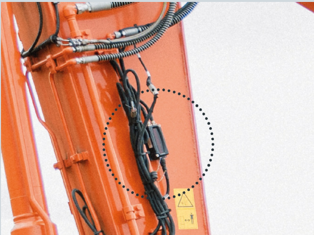
Integration eines Rotationslasers
