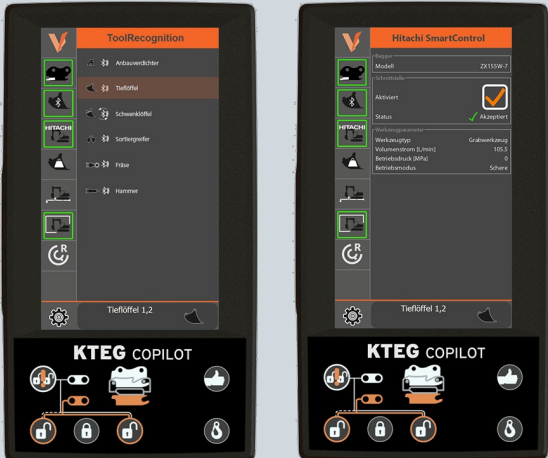
Automatische Werkzeugerkennung und -einstellung
