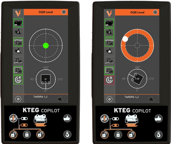
OQR Level - integrierte Wasserwaage
