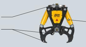
Zylinder gekapselt, geschützt mit Druckübersetzer für Arbeiten bei 500 bar (bis zu 70 Tonnen Brechkraft)
