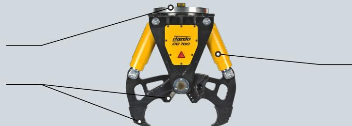
Zylinder gekapselt, geschützt mit Druckübersetzer für Arbeiten bei 500 bar (bis zu 70 Tonnen Brechkraft)
