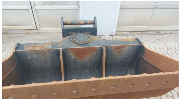
**Rädlinger, Grabenräumlöffel schwenkbar
