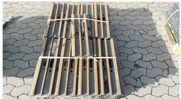
Hitachi, Bodenplatten 650mm Zweisteg,
