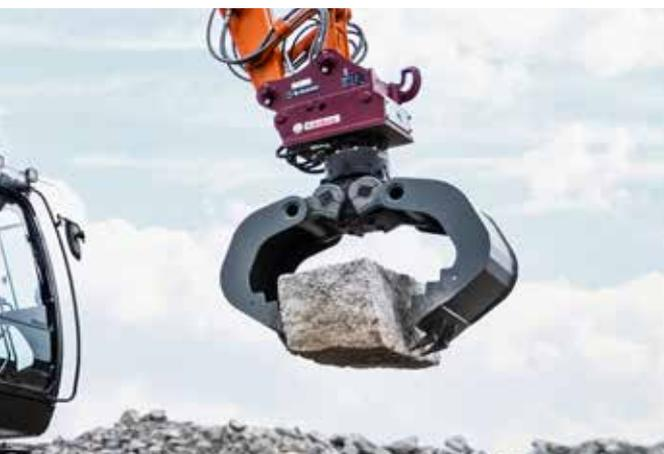
Unsere Abbruch- und Sortiergreifer von DEMAREC sind ideal für Arbeiten im Abbruch, Recycling und GaLaBau ausgelegt. Das vollständig geschlossene Demadrive-Gehäuse arbeitet wartungsfrei und ist wasser- und staubdicht. Bei permanent konstanter Schließkraft und -geschwindigkeit behalten Sie stets die Kontrolle.
