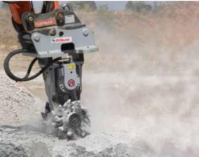
Leistung und Effizienz sind die herausragenden Merkmale unserer ROCKWHEEL Anbaufräsen. Die Antriebskonzepte sind der Maschinenklasse angepasst und erreichen damit das Maximum an Lösekraft. Unsere Fräsen arbeiten lärm- und vibrationsarm. Auch Einsätze unter Wasser sind kein Problem. Ohne weitere Vorkehrungen kann die Fräse unter Wasser eingesetzt werden und löst so Gesteinshärten bis ca. 110 MPa.
