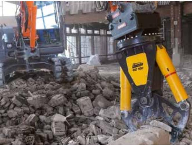
Die Abbruchscherer CC700 von DARDA ermöglicht den Einsatz von leichten und kompakten Minibaggern bei anspruchsvollen Abbrucheinsätzen.
