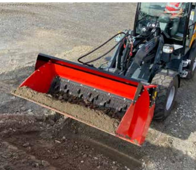
ALLU Schaufelseparatoren eignen sich ideal zum Sieben von Störstoffen zur, Aufbereitung und Mischen von Böden sowie zur Verarbeitung und Belüften von Kompost oder Restmüll direkt am Einsatzort. Je nach Anwendungsfall und Durchsatzmenge können die Schaufelseparatoren mit unterschiedlichen Wellentypen ausgestattet werden. Die Wellen können je nach Einsatzgebiet zur gewünschten Korngrößen eingestellt und ausgetauscht werden.
