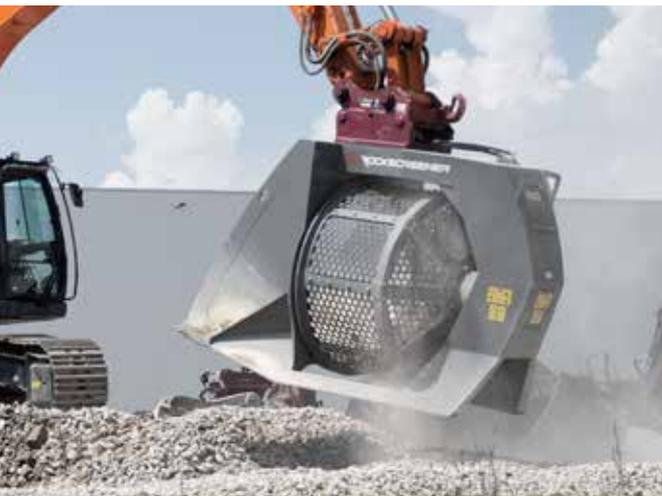
Die Rockscreener sind unverzichtbare Werkzeuge für das Absieben von Feinanteilen aus Materialien für unterschiedliche Verwendungen. Durch das große Ladevolumen können große Mengen schnell und mit geringem Aufwand getrennt und weiterverarbeitet werden.
