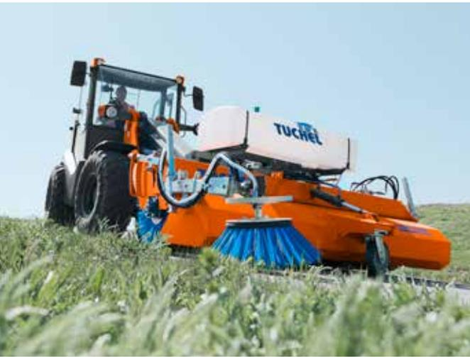
Hydraulisch angetrieben für Radladeranbau, Kommunalfahrzeuge oder Traktoren. Robuste Besen, leistungsstarke Antriebsmotoren und mit zahlreichen Ausstattungsmöglichkeiten:
