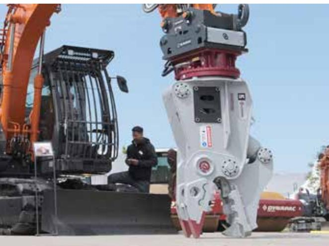
Die neuen DLP ecoline Modelle wurden speziell als wettbewerbsfähige und kraftvolle Pulverisierer entwickelt. Für einfache Abbrucharbeiten, selbst mit kompakten Trägergeräten in der Qualität, die Sie von DEMAREC erwarten können. Das bewährte Verschleißkonzept wird konsequent umgesetzt: Der Arbeitsbereich bleibt vollständig geschützt. Ein schneller und unkomplizierter Austausch der Verschleißteile ist problemlos am Einsatzort durchzuführen und sichert so unterbrechungsfreie Produktivität.
