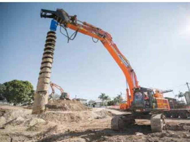
Der Erdbohrer von ABI wird schnell und einfach mit dem Schnellwechsler aufgenommen. Er ermöglicht verrohrtes Bohren mit Rohrdurchmessern bis zu 820 mm.
