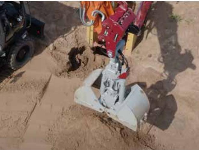
Ob im Verbau, auf der Kanalbaustelle, in der Rückverladung oder bei universellen Einsätzen bieten die Zweischalen-Tiefbaugreifer über das natürliche Einsatzspektrum eines Tief- oder Grabenlöffels hinaus weitreichende Vorteile. Gezieltes Greifen, kraftvolles Graben oder die Bewältigung schier endloser Verladearbeiten sind mit einem Zweischalengreifer kein Problem!
