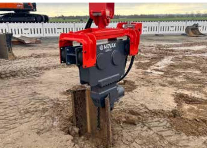
Für kleinere, einfachere Bauvorhaben sind die MOVAX EMV Rammgeräte besonders geeignet: die konventionelle Hydraulikversorgung des Baggers ist ausreichend. Es wird keine zusätzliche Steuerung benötigt. EMV-Rammern arbeiten im Hochfrequenzbereich und sind damit perfekt für Rammmanwendungen selbst bei schwierigen Bodenverhältnissen geeignet.
