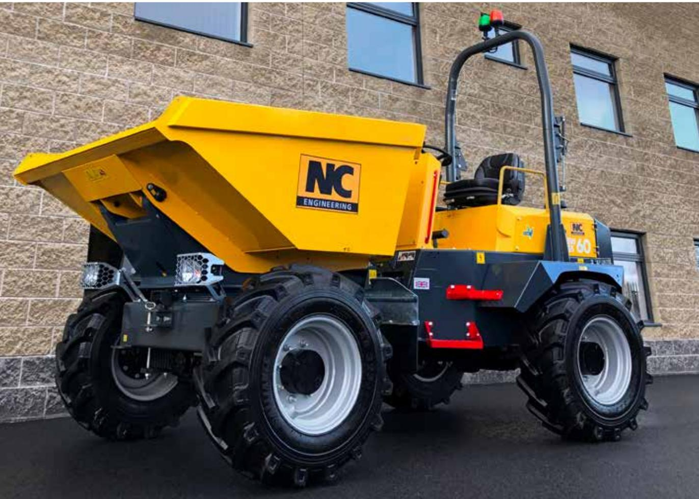
Unsere Kompaktdumper von NC Engineering verfügen über eine Kipp- und 180° schwenkbare Mulde.
