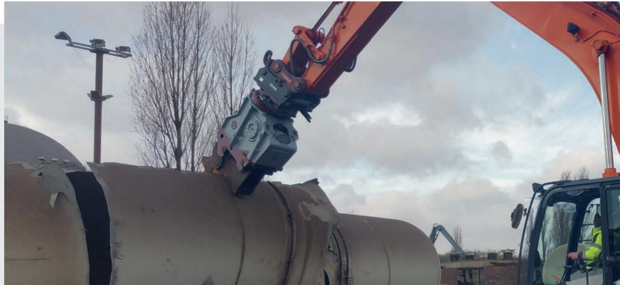
MQP mit Tankgebiss - Effizientes Zerlegen von Tankwagen, Silos oder Windkraft-Anlagen
