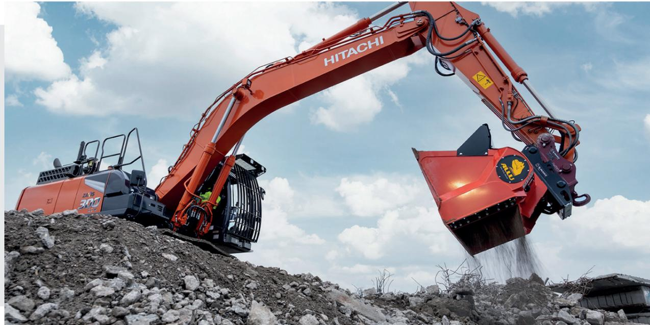
Allu Schaufelseparatoren eignen sich ideal zum Sieben von Störstoffen, zum Aufbereiten und Mischen von Böden, zum Verarbeiten und Belüften von Kompost oder Restmüll direkt am Einsatzort. Die mobilen Geräte sind sowohl für Radlader- als auch Baggeranbau erhältlich.
