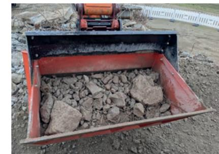
Mischen, Sieben, Brechen - Bodenaufbereitung und Rückverfüllung direkt am Einsatzort.
