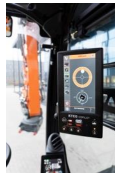
C2501_One-Monitor-Solution.jpg Mit einem einzigen Monitor im Cockpit haben Baggerfahrer eine bessere Übersicht im Führerhaus und trotzdem alle wichtigen Werte und Informationen der Assistenzsysteme im Blick.
