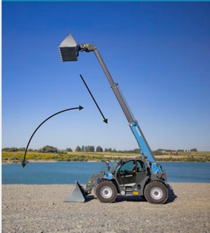
Beim Absenken der Ladeanlage wird der Teleskoparm automatisch eingezogen. So wird die Ladung immer so nah wie möglich am Fahrzeug geführt und es kommt auch bei maximalen Nutzlasten nicht zu kritischen Situationen. Der Schaufelmodus eignet sich ideal für die Verladung von Schüttgütern.
