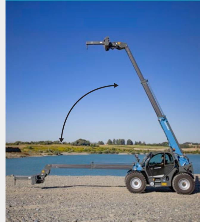
Im manuellen Modus werden von der Maschine keine automatischen Bewegungen der Ladeanlage ausgeführt. Der Überlastschutz ist selbstverständlich weiterhin aktiv und stoppt die Ladeanlage sobald die Überlastgrenze erreicht wird. An diesem Punkt sind nur noch das Einteleskopieren, das Anheben der Ladeanlage und das Auskippen des Anbaugeräts möglich.
