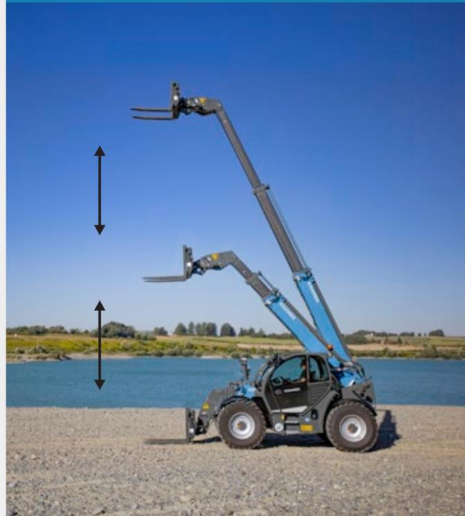
Beim Anheben und Absenken der Ladeanlage wird das Anbaugerät in einer vertikalen Linie nach oben und unten bewegt, das heißt der Teleskoparm fährt automatisch aus und ein und die Ladung wird in einer geraden Linie nach oben bzw. unten gefahren. Somit bleibt die Ladung immer im sicheren Bereich und die Stapelarbeit in großen Höhen wird vereinfacht.
