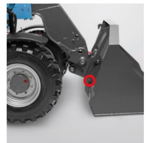
**Hydraulischer Gerätewechsel (optional) - Das Kramer Schnellwechselsystem:** An das Anbaugerät heranfahren, das Anbaugerät vom Fahrersitz aus aufnehmen und per Rolltaster am Joystick hydraulisch verriegeln. Der Verriegelungszyylinder liegt außerhalb vom Drehpunkt der Schnellwechselfplatte und ist somit nicht im Schmutzbereich.
