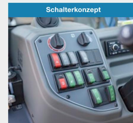
Alle Schalter und Taster der Maschine sind farblich markiert, sodass der Fahrer die gewünschte Funktion schneller finden kann. Die Taster mit einer Sicherheitsfunktion sind rot, die für die Hydraulik sind grün, für die Elektrik grau und für den Fahrantrieb blau. Um auch bei Dunkelheit immer den richtigen Schalter nutzen zu können, leuchten alle Bedienelemente.
