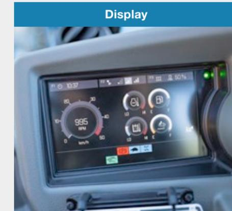
Der Teleskoplader besitzt ein modernes Bedienkonzept mit großem 7-Zoll LCD Display. Der Aufbau des Displays ist einfach und intuitiv gehalten. Alle wichtigen Fahrzeugdaten und Funktionen werden im Hauptmenü angezeigt. Die Helligkeit lässt sich regulieren und individuell Ihren Bedürfnissen anpassen. Die optionale Rückfahrkamera ermöglicht eine verbesserte Sicht nach hinten.
