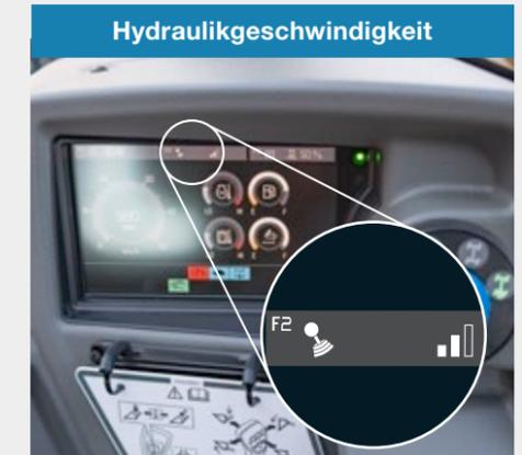
Über das Display und das Jog Dial kann die Geschwindigkeit der Arbeitshydraulik für das Heben- und Senken des Hubarms sowie das Ein- und Auskippen der Anbaugeräte in drei Stufen angepasst werden. Der Fahrer kann dadurch immer das richtige Maß zwischen Geschwindigkeit und Präzision auswählen.
