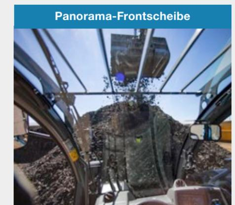
Jederzeit alles im Blick: Alle Kramer Teleskoplader haben eine durchgehende Frontscheibe, ohne störende Querstreben. Die Scheibe wurde so weit wie möglich nach oben und unten gezogen, sodass der Fahrer die Verriegelungsbolzen beim Anbaugerätewechsel sofort sehen kann und das Anbaugerät auch bei maximaler Arbeitshöhe noch im Sichtfeld behält.
