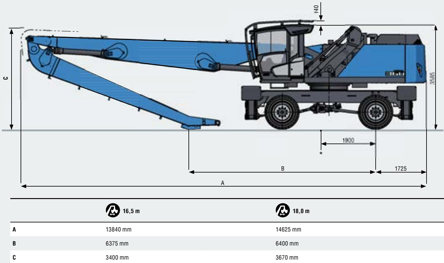
**18,0 m****Work equipment Banana Boom | Arbeitsausrüstung gekröpfter Ausleger | Équipement de travail de flèche coudée****Equipos de trabajo de pluma acodada | Attrezzatura di lavoro braccio piegato a gomito | Equipamento de trabalho da lança acotovelada**
