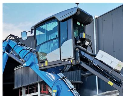
**KABINE MIT OPTIONALER STAUBSCHUTZANLAGE**
