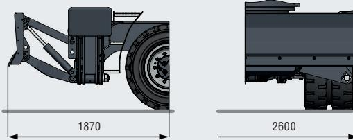
**2-point Stabilizers and support blade | 2-Punkt-Abstützung und Stützschild | 2 stabilisateurs et lame d'appui
