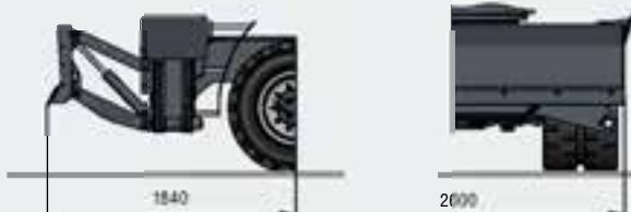
**2-point Stabilizers and support blade | 2-Punkt-Abstützung und Stützschild | 2 stabilisateurs et lame d'appui**
