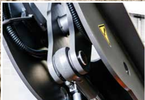
Die Verlegung von Schläuchen und Kabeln im Inneren des Monoblock-Auslegers schützt wichtige Komponenten.
