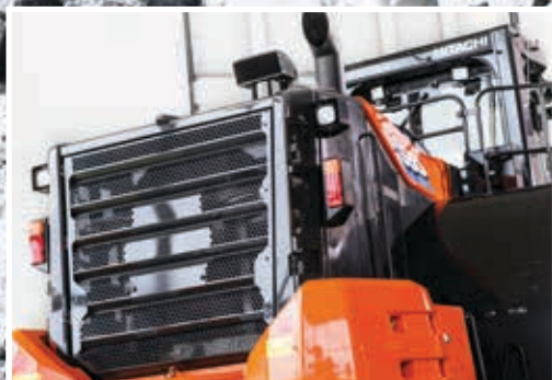
Der neue Heckgrill schützt den Kühlerraum.
