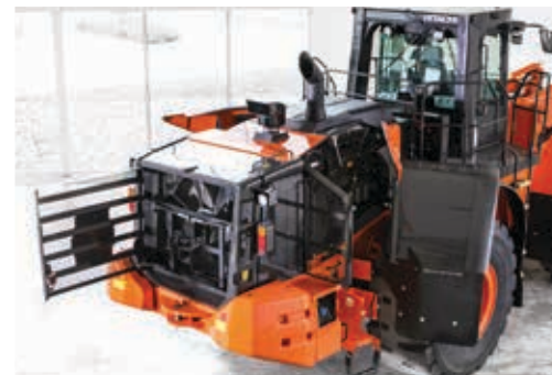
Einfacher Zugang zum Motorraum.
