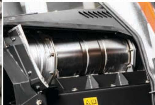
Das SCR-System reduziert Emissionen und den Lärmpegel.
