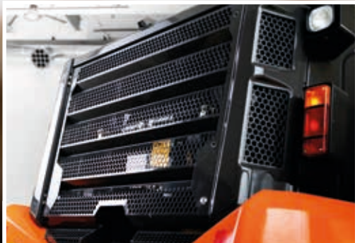
Der neue Heckgrill schützt den Kühlerraum.
