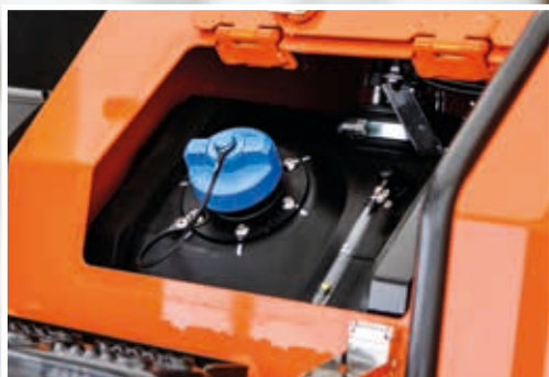
In den Abgasstrom wird Harnstoff eingespritzt, um Emissionen zu reduzieren.
