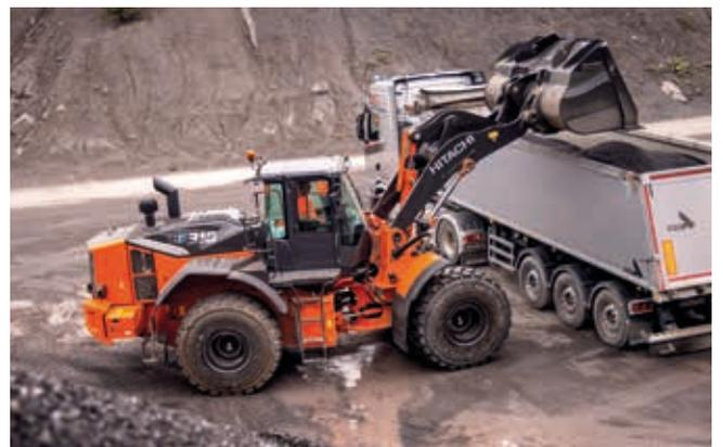
Durch das Approach Speed Control wird die Effizienz beim Beladen maximiert.
