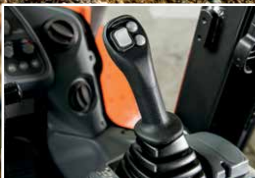
Der Power-Schnellschalter erhöht bei Bedarf die Motorleistung.
