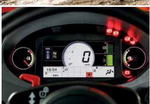
Auf dem LCD-Monitor werden Informationen zum Maschinenstatus und Einstellungen angezeigt.
