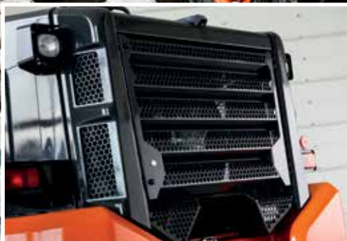
Der neue Heckgrill schützt den Kühlerraum.
