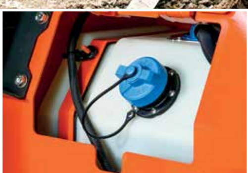
Der Harnstofftank ist sicher und bequem vom Boden aus zugänglich.
