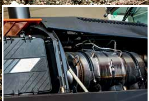
Das SCR-System reduziert Emissionen und den Lärmpegel.
