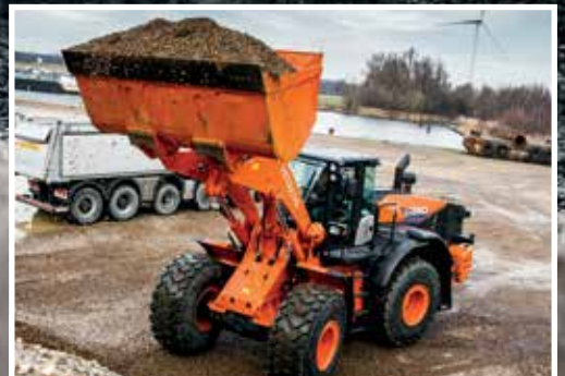
Das Durchflussregelungssystem sorgt für eine gleichmäßige Bewegung des Hubarms.
