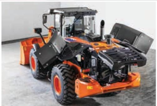
Einfacher Zugang für Wartungsarbeiten vom Boden aus.
