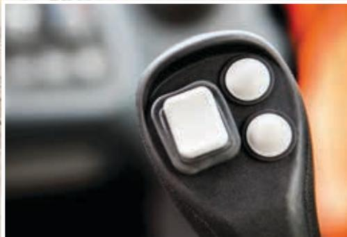
Der Power-Schnellschalter erhöht bei Bedarf die Motorleistung.
