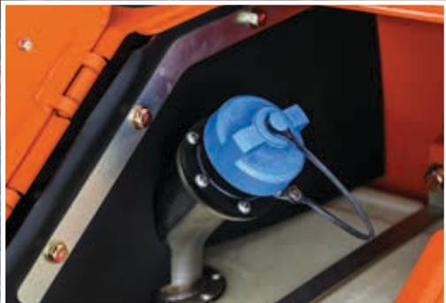
In den Abgasstrom wird Harnstoff AdBlue eingespritzt, um Emissionen zu reduzieren.
