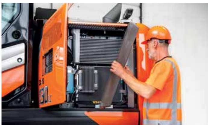
Powiększone drzwi chłodnicy (ZX130-7B) zapewniają łatwy dostęp w celu czyszczenia i konserwacji.
