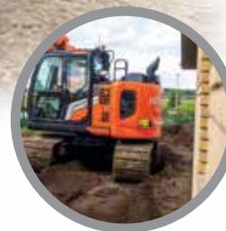
Durch den kurzen Heckschwenkradius eignet sich der ZX135US-7B ideal für Arbeiten auf engstem Raum.
