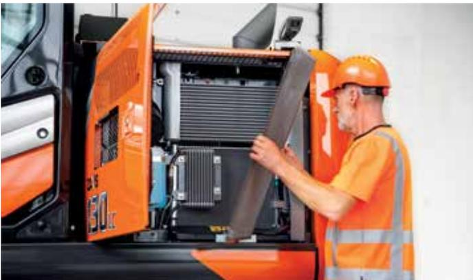
Die größere Kühlerabdeckung (ZX130-7B) bietet einen einfachen Zugang für die Reinigung und Wartung.
