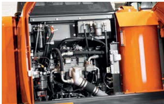
Układ hydrauliczny HIOS III przyczynia się do znaczącej redukcji zużycia paliwa.
