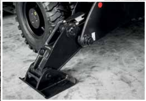
Die Zuverlässigkeit wird durch eine verstärkte Zylinderabdeckung des Abstützpratzens erhöht.
