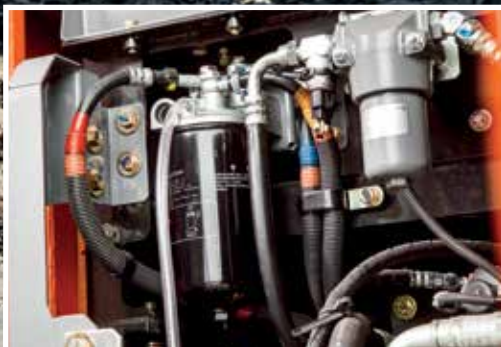
Der Kraftstoffhauptfilter lässt sich einfacher auswechseln.
