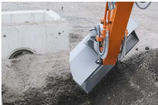
Böschungen und Schrägen mit Rotation problemlos, ohne Tilt.
