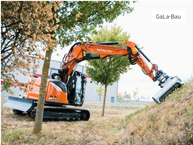
Hitachi ZX95US-7 VA MTC mit KTEG 360° mit Mulcher.
