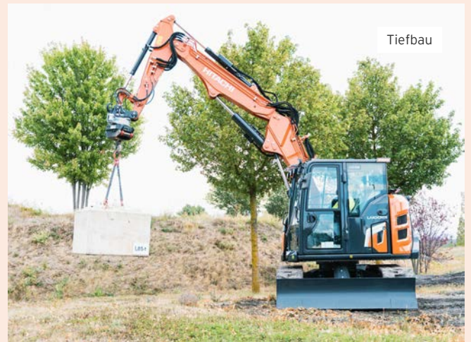
Hitachi ZX95US-7 VA MTC mit KTEG 360° mit Lasthaken.
