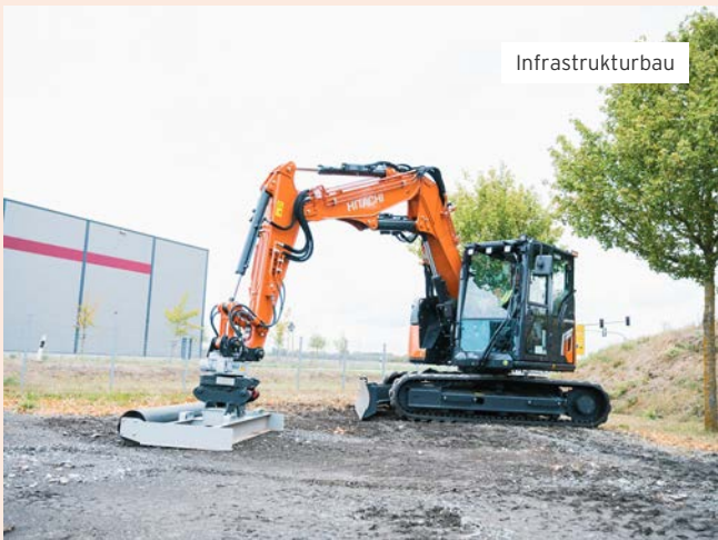
Hitachi ZX95US-7 VA MTC mit KTEG 360° mit Planierbalken.
