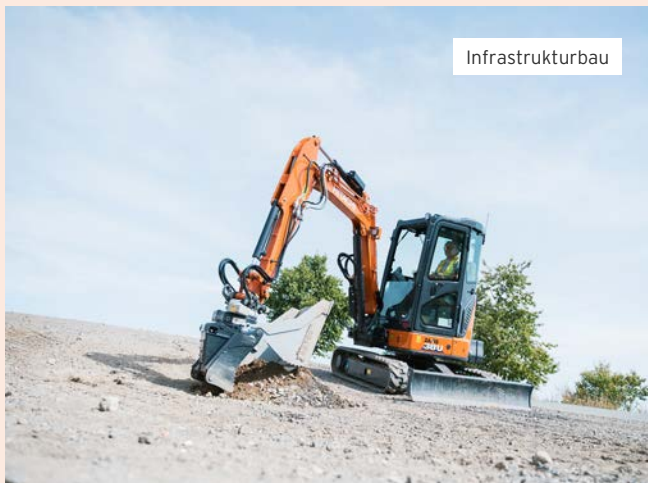
Hitachi ZX38U-6 MTC mit KTEG 360° 6-in-1 Klappschaufel.
