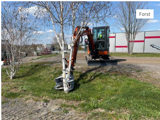
Hitachi ZX38U-6 MTC mit KTEG 360° Baumschere.
