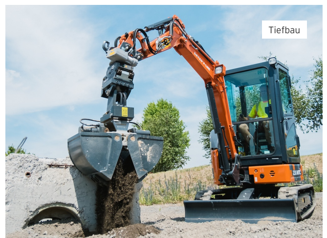
KTEG 23U-6 MTC mit KTEG 360° Zweischalen-Tiefbaugreifer.
