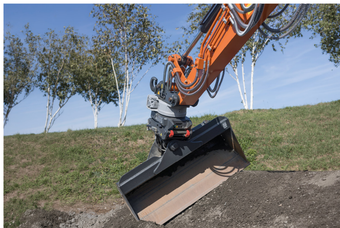
Bei Bedarf ist der KTEG OQR jederzeit mit Tilt kombinierbar
