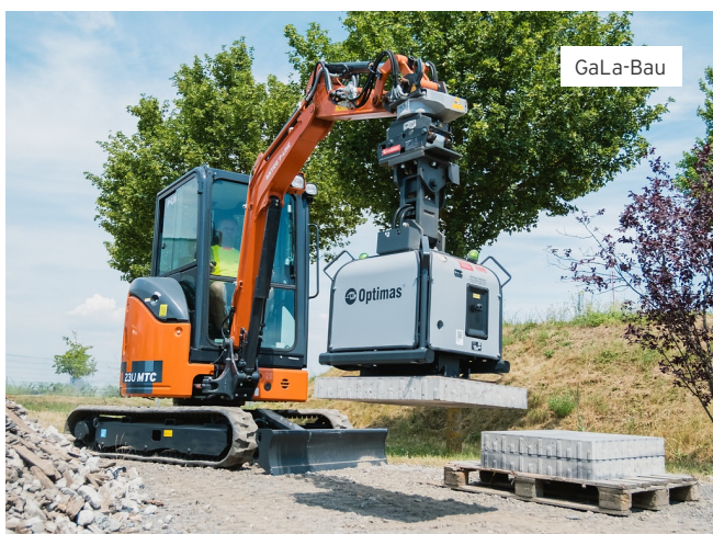
KTEG 23U-6 MTC mit KTEG 360° Vakuumhebegerät.
