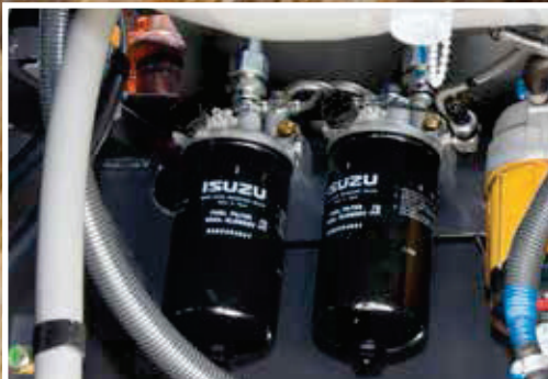
Der Kraftstoffhauptfilter lässt sich einfacher auswechseln.
