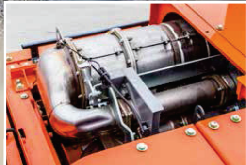
Das SCR-System reduziert Schadstoffausstoß.
