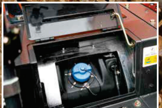
Harnstoff wird in die Abgase eingespritzt, um Emissionen zu senken.
