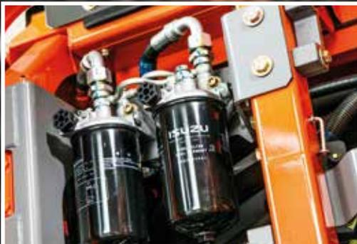
Der Kraftstoffhauptfilter lässt sich einfacher auswechseln.
