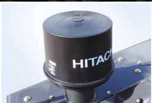
Durch den optional erhältlichen Vorfilter kann der Filterwartungsaufwand deutlich reduziert werden.
