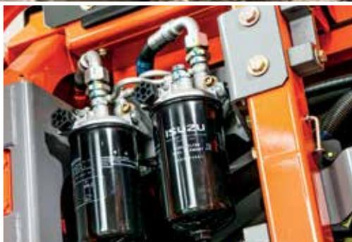
Der Kraftstoffhauptfilter lässt sich einfacher auswechseln.
