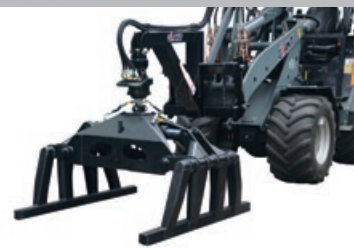
STEINKLAMMER GA300 Spannbereich: 72 - 115 cm Maximale Schichthöhe: 30 cm
