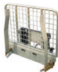
STEINZANGE GA300 Spannbereich: 78 - 112 cm
