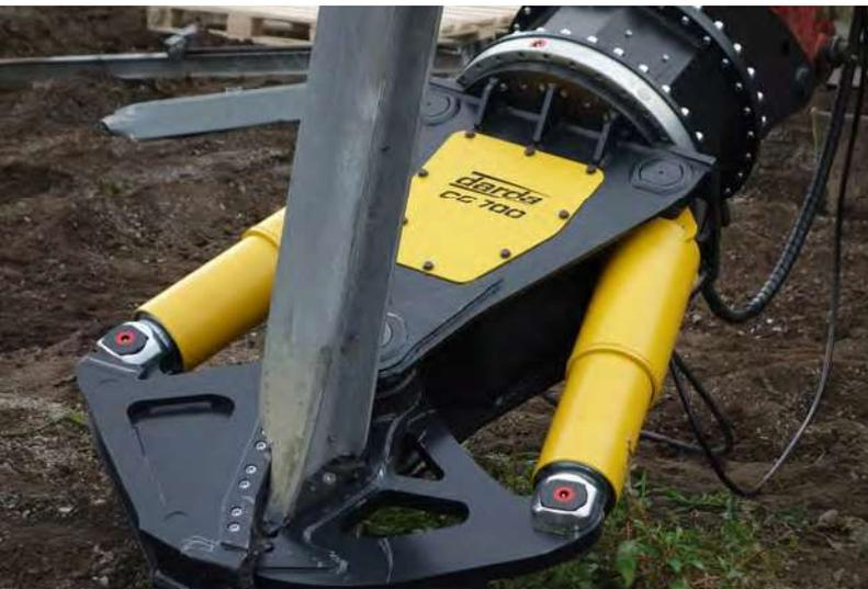
Ob als Anbaugerät am Bagger, LKW-Kran oder Brokk Abbruchroboter: Jede Menge – auch eher ungewöhnliche Einsätze – können Sie mit dem starken und robusten Stahlschneider meistern. Alles ist möglich: Wie hier das Zerkleinern von Flugzeugwracks in einem Fliegerhorst.
