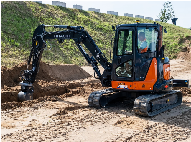
Der 360° drehbare Tieflöffel ermöglicht präzises Arbeiten ohne Umpositionieren des Baggers
