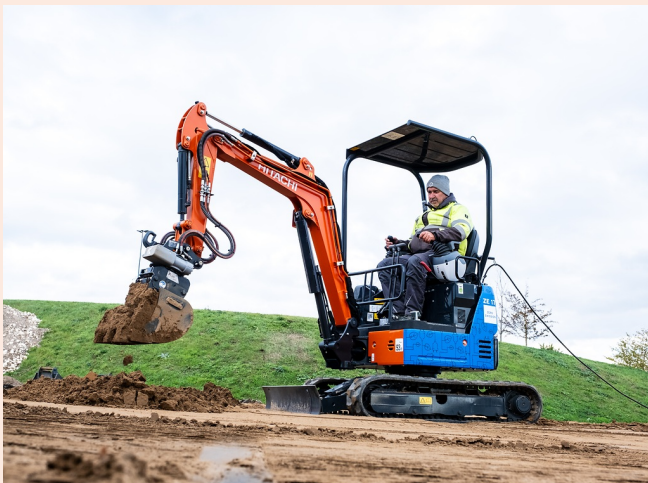
Hochlöffelmodus durch 360°-Rotation - optimale Materialführung in jeder Löffelstellung
