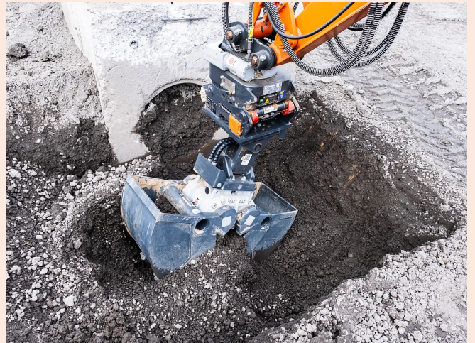
Alle Schläuche sind innenliegend: Keine Beschädigungsgefahr, kein Baustellenstillstand
