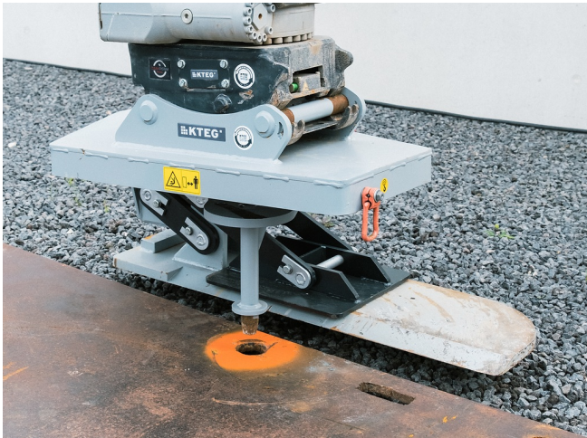
Positionierung Dorn direkt über der Bohrung
