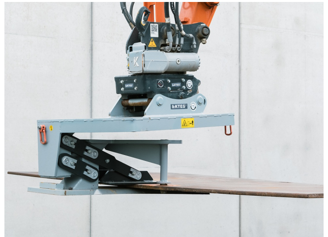
Kraftschlüssiges Anheben und Verlegen der Stahlplatte
