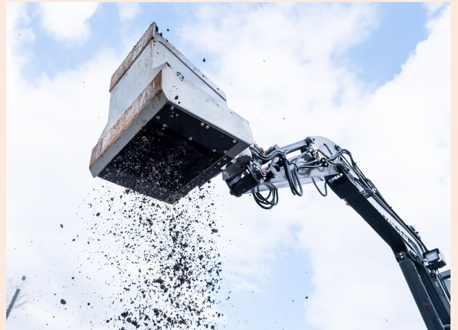
Effizientes Trennen von Erdreich, Bauschutt oder Kompost durch rotierende Siebwellen
