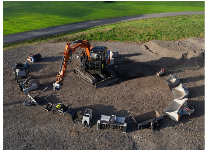
Für jede Anwendung das passende Anbaugerät in 10 s angebaut und sofort einsatzbereit
