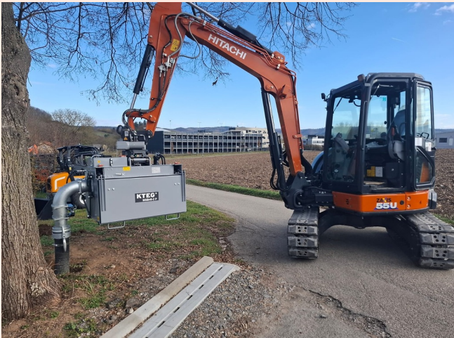
Mit KTEG OQR: Kein Drehwerk an Anbaugeräten erforderlich, reduzierte Aufbauhöhe und Gewicht
