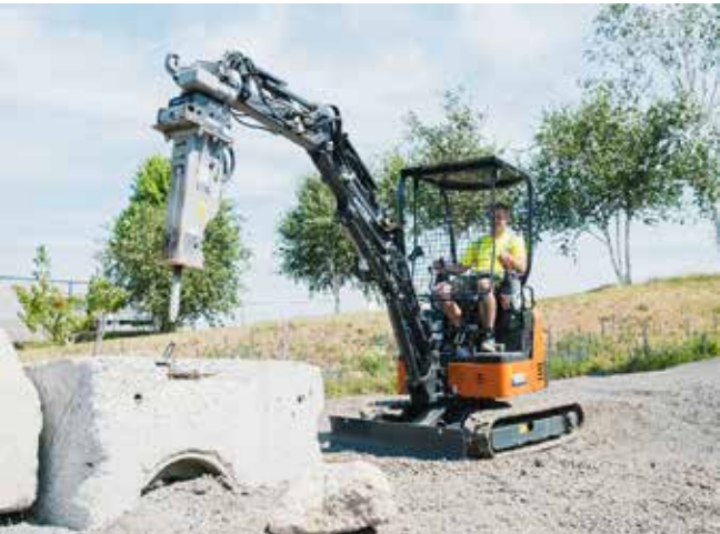
Hohe Schlagkraft Effizientes Brechen von Beton, Asphalt und Gestein für schnelle Arbeitsfortschritte auf der Baustelle.
