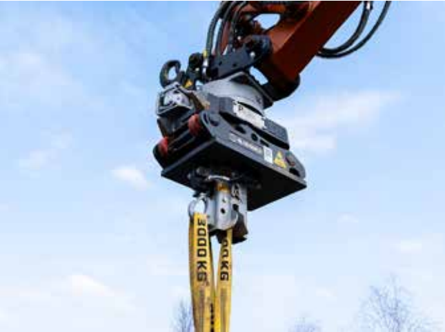
Hydraulische Klappe Automatische Entriegelung des Schlupfs.
