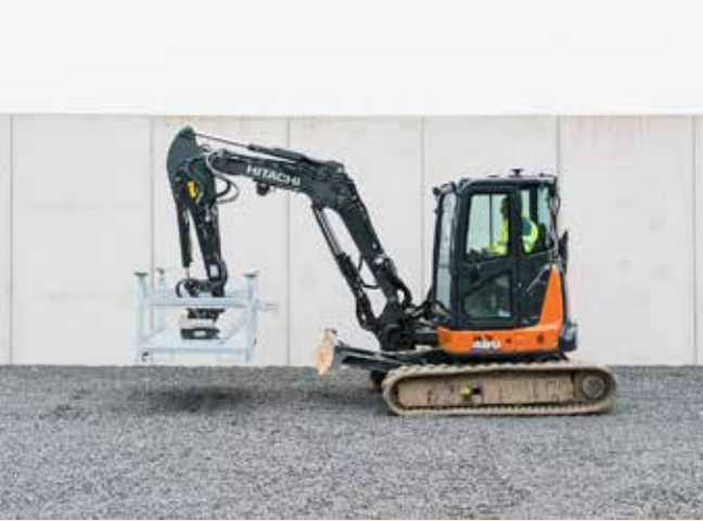
Schneller Wechsel Integrierte OQR-Schnellwechsellaufnahme ermöglicht eine zusätzliche Transportmöglichkeit.
