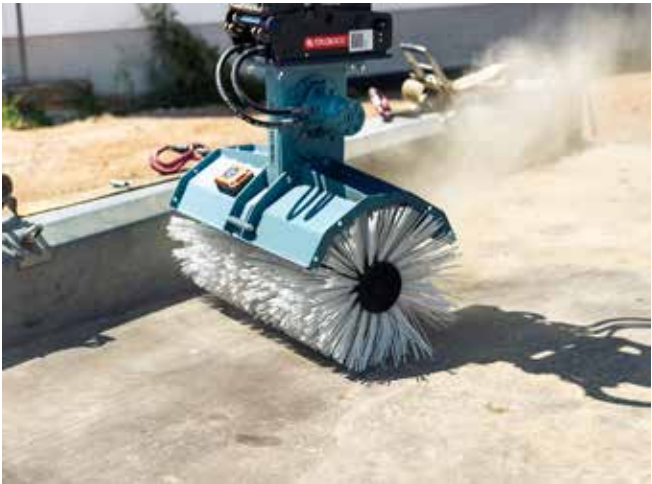
Kehrwalzenaufsatz Schnelle und effiziente Reinigung von Baustellen und Arbeitsbereichen.
