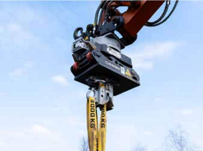
Hydraulische Klappe Automatische Entriegelung des Schlupfs.
