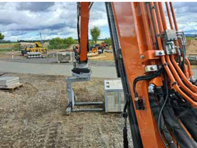
Flexible Lastaufnahme Nimmt Lasten auch seitlich sicher auf.
